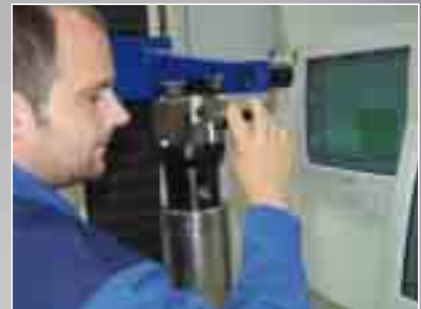
Präzise Einstellung der Sonderwerkzeuge auf einem Einstellgerät
