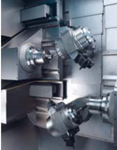
Das Multifunktionszentrum R200 von Index hat keinen Revolver mehr. Sowohl stehende Tools fürs Drehen als auch rotierende für Fräsen werden aus dem Magazin in die Spindel eingewechselt Bild: Index
