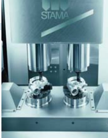
Die 2-spindlige Drehbearbeitung stellt höchste Anforderungen an die Positionier- und die Wechselwiederholgenauigkeit der Werkzeug-schnittstelle sowie die Radialfixierung der Werkzeuge Bild: Stama
