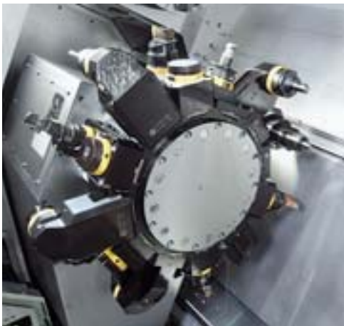
Der Sauter-Revolver Baugröße 20 mit HSK-Schnittstelle und integriertem Antrieb, wie er auf dem Gildemeister-Dreh-Fräszentrum GMX 400 linear bei der Firma Wohlhaupter im Einsatz ist
