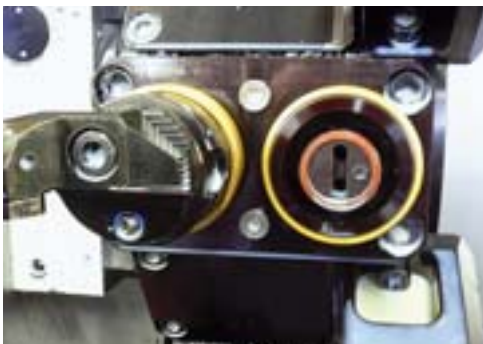
Jeder Platz im Sauter-Revolver kann mit zwei HSK-Werkzeuge für die Vor- und Rückwärtsbearbeitung ausgerüstet werden
