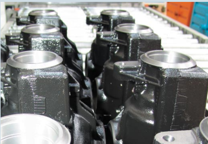
Anspruchsvolle Aufgabe: Die Getriebegehäuse werden auf zwei Mazak-Bearbeitungszentren komplett bearbeitet.
