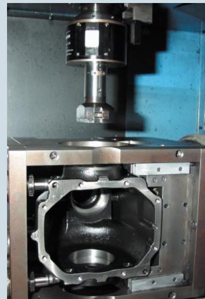
Heute wird das Innen-Einstechen der beiden Nuten in einem einzigen Arbeitsgang erledigt – die Bearbeitungszeit sank von 120 auf nur noch 40 Sekunden. Bilder: Frick
