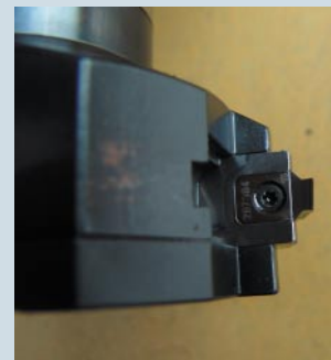
Auch die Stechplatten hat Wohlhaupter exakt auf die Anwendung hin maßgeschneidert.
